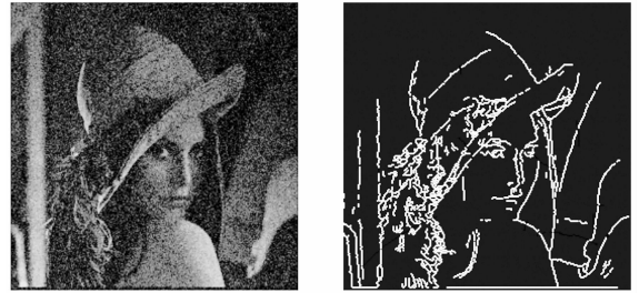
(a)暗化的噪声 Lena 图像 (b)方法 1 边缘检测结果 (a)Noisy Lena image (b)Detected edge by method 1
